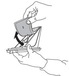
Fissare la schiuma espansa al filtro inferiore. Pulire la camera del filtro dell'asciugatrice con un panno umido o con cautela con un'aspirapolvere. Reinserrire il filtro inferiore. Abbassare la maniglia del filtro e chiudere lo sportellino inferiore.
