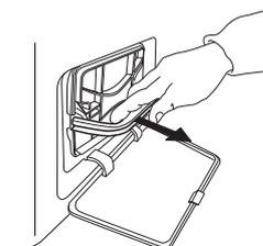
Rimuovere la schiuma espansa dal filtro inferiore per pulirlo. Pulire la schiuma espansa e il filtro manualmente o sotto acqua corrente. Non lavare la schiuma espansa nella lavatrice. Strizzare la schiuma espansa del filtro. Non inserirla nel filtro inferiore ancora gocciolante.
