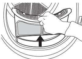
Premere il tasto per aprire il filtro pelucchi. Rimuovere i pelucchi presenti al suo interno. Chiudere il filtro e reinserirlo nella direzione corretta in modo che si inserisca completamente nella relativa camera.
