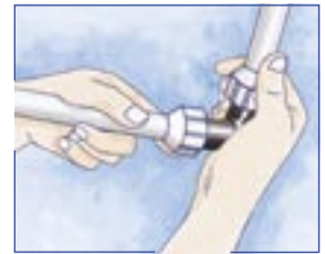
2. Spingere il tubo per far passare la guarnizione. Inserire l'estremità del tubo nel raccordo ed avvitare il dado di compressione.
