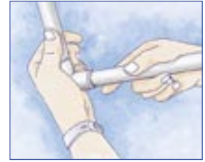
2. Inserire il tubo nell'unione e pulire l'eccesso di colla.
