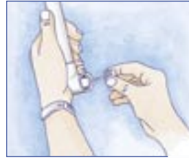
A. Unendo PVC: 1. Mettere della colla sia dentro l'unione che fuori dal tubo.
