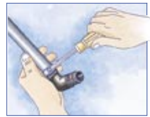
Tubo di Polietilene: 2. Stringere l'anello attorno al tubo e al raccordo.
