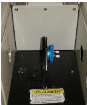
Figura 4.9: particolare del supporto contenente la finestra di Fluoruro di Calcio
