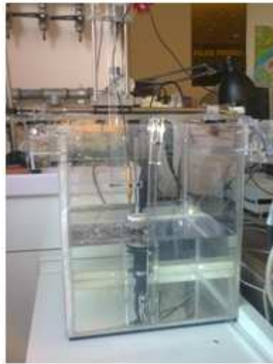
Figura 4.4: set up sperimentale per la caratterizzazione del campo acustico prodotto dal trasduttore.
