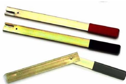
Fig. 18: Leva di azionamento con impugnatura rossa per messa a terra e rimozione della messa a terra, con impugnatura nera per sezionamento sotto carico/di potenza. Alternative: comando a leva unica e leva antiriflesso (l'inversione della direzione di comando richiede la modifica della leva)
