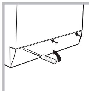
3. rimuovere il pannello di copertura sul lato anteriore della lavabiancheria con l'aiuto di un giravite (vedi figura).
