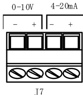
Sul connettore J7 sono disponibili due ingressi analogici "generici" uno è adatto per segnali di tensione con range 0-10V mentre il secondo permette il collegamento di trasduttori 4-20mA. I dati acquisiti attraverso queste porte vengono trasformati dallo String Box nelle relative grandezze fisiche misurate. Per la configurazione di tale trasformazione si rimanda al relativo software.
