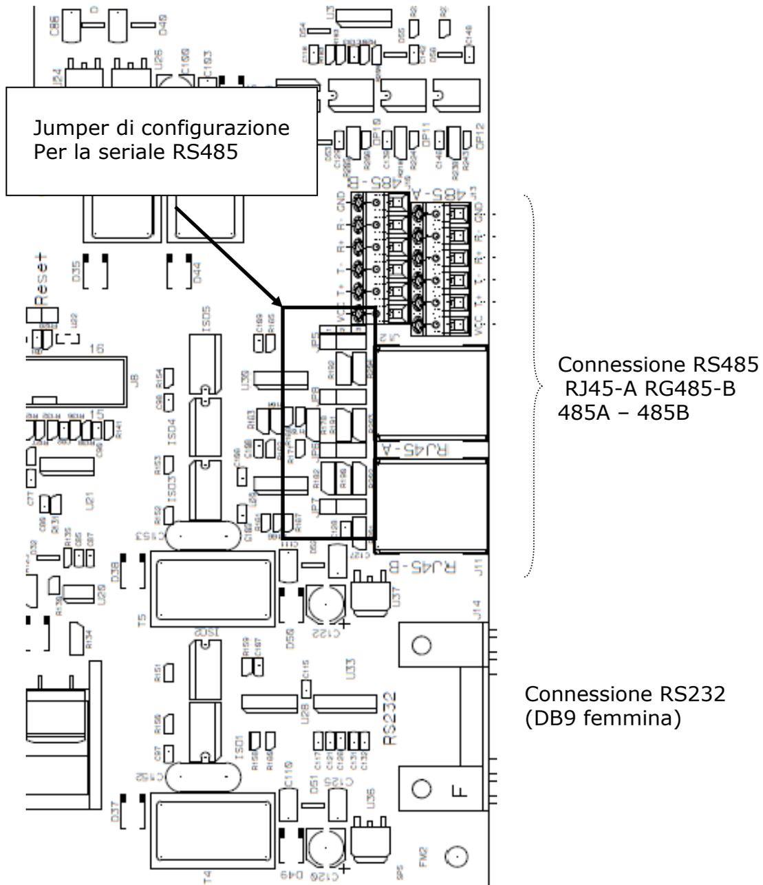
La porta RS232 è un connettore a 9 poli femmina che permette il collegamento di un unico "String Box" ad un PC per la configurazione ed il monitoraggio dello stesso. Il cavo necessario alla connessione è di tipo PIN to PIN.
