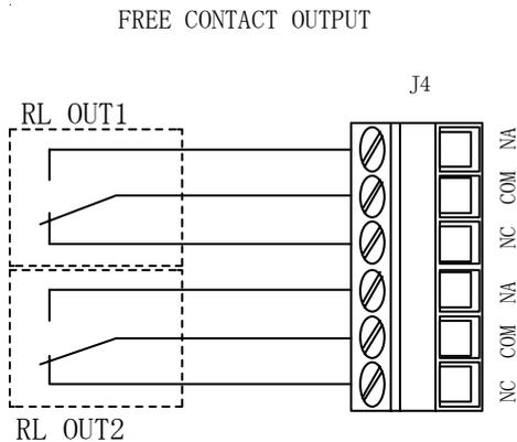
Sul connettore J4 della scheda di controllo dello String Box sono disponibili i contatti di scambio di due relè. Si veda la figura a fianco per la posizione dei contatti (il disegno mostra lo stato di relè NON eccitati).
