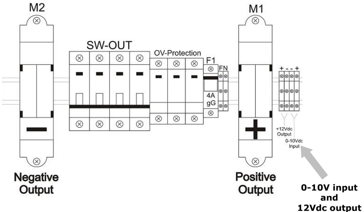
Nella configurazione standard l'ingresso di tensione 0-10V è configurato per il collegamento di un sensore di irraggiamento con  $0V=0W/m^2$  e  $10V=1200W/m^2$ . Si rimanda al manuale del software di configurazione per maggiori dettagli sulla configurazione dell'ingresso 0-10V
