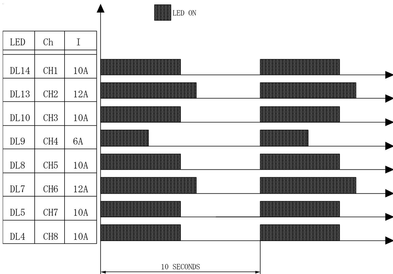
Durante il corretto funzionamento dell'impianto, quando le stringhe stanno erogando la stessa corrente i LED relativi ai vari canali si accendono e si spengono praticamente contemporaneamente.
