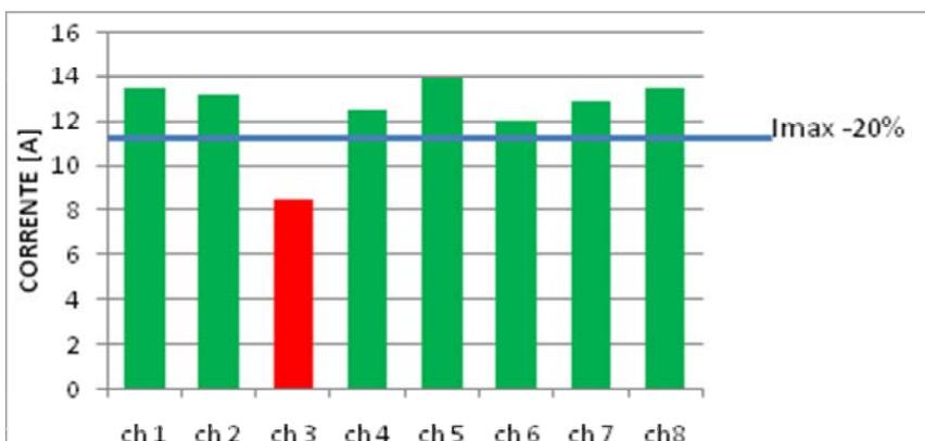
Il canale ch3 presenta una corrente inferiore alla soglia di allarme. Se tale situazione perdura per più del tempo specificato dal parametro **TIME\_ALL** viene generato un allarme.
