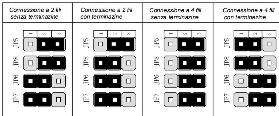
La connessione al bus RS485 può essere fatta attraverso connettori a vite oppure con dei cavi intestati con connettore RJ45. Tutti i connettori sono collegati tra di loro in parallelo, è quindi possibile scegliere una qualunque combinazione di connettori per effettuare l'entra-esce tipico del bus 485. Per la corretta connessione vedere le figure seguenti.
