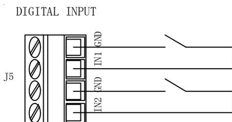
Sul connettore J5 della scheda a microprocessore sono disponibili due ingressi digitali galvanicamente isolati dal potenziale della logica di controllo. Lo stato di tali ingressi è monitorato dallo String Box e può essere associato ad un allarme. Nella configurazione di default l'allarme è generato quando il contatto viene chiuso, ma
