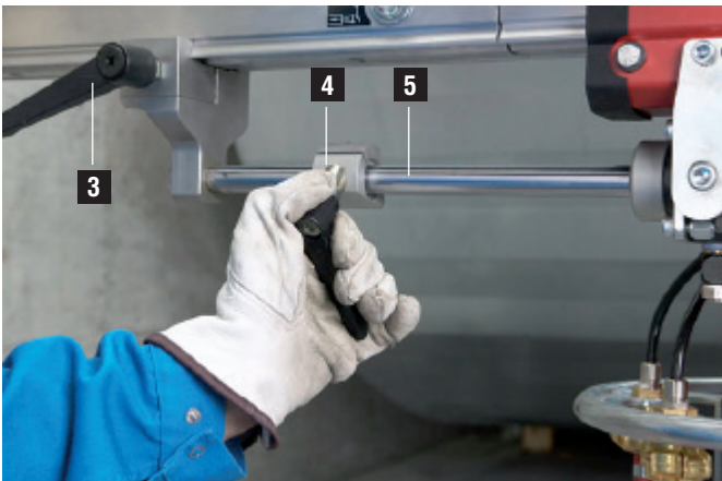
3 Fissaggio dello stelo del pistone
