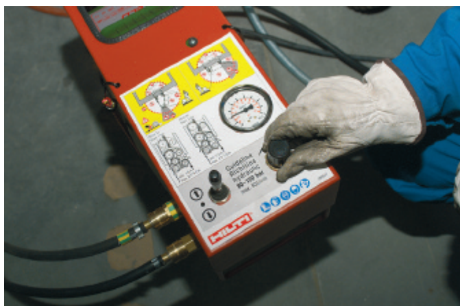
Impostare la pressione d'avanzamento (DS WS10).
