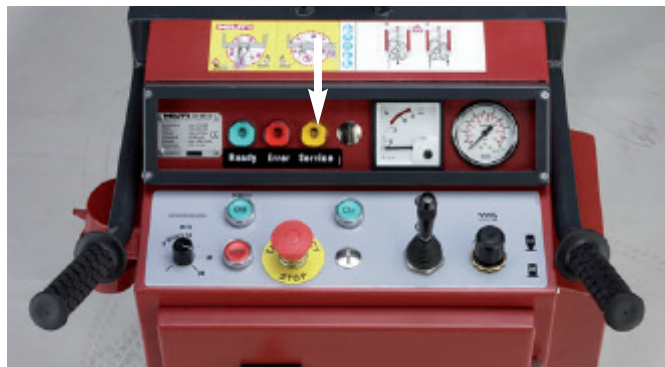
10.18 L'ingresso di corrente è troppo alto durante il regime minimo e il taglio (DS WS10-E)
