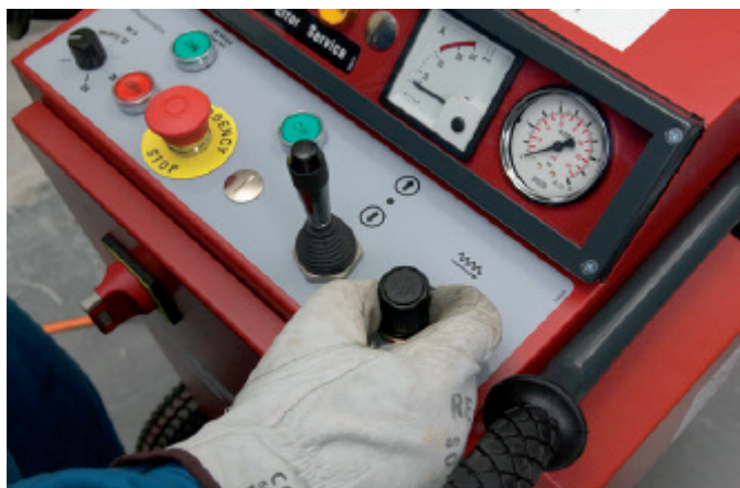
Impostare la pressione d'avanzamento (DS WS10-E).
