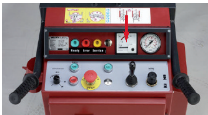
10.18 L'ingresso di corrente è troppo alto durante il regime minimo e il taglio (DS WS10-E)
