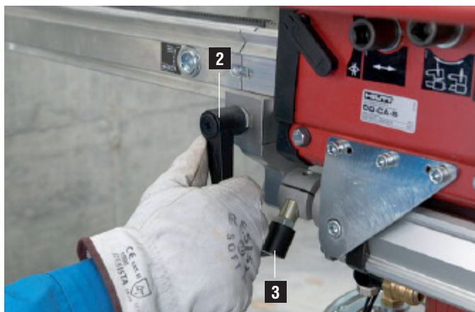
2 Dispositivo di fissaggio dello stelo del pistone
