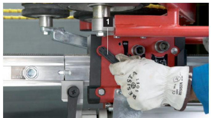
1 Leva di bloccaggio del movimento di avanzamento
