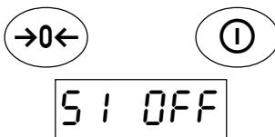
Bei ausgeschalteter Waage die Taste →0← drücken und gedrückt halten. Waage mit der Taste ⓧ einschalten.
