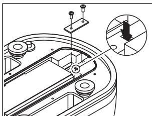
Con un pequeño destornillador de ranura, cortocircuite los dos contactos en la abertura rectangular (ver flecha).
