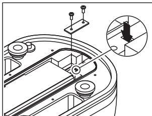
Bei eingeschalteter Waage die Akkuabdeckung auf der Waagenunterseite entfernen (6 Schrauben). Kalibrierplatte entfernen (2 Schrauben), dazu muss der Aufkleber zerstört werden, der eine der beiden Schrauben abdeckt.
