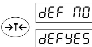
Die Rücksetzung aller Einstellungen auf die Werkseinstellungen ist nur im **Service-Mode** möglich und zwar im Menüblock "DEF" ("Default"). Wenn Sie die Werkseinstellungen wieder herstellen wollen, wählen Sie "DEF YES" und bestätigen dies mit der Taste ①. Drücken Sie anschliessend die Taste →T← und bestätigen Sie die Rückfrage "SAVE" mit der Taste ①. **Achtung: Bei der Rücksetzung gehen alle individuellen Einstellungen verloren!**
