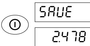
Si desea guardar las configuraciones, pulse la tecla ①. Una vez guardadas, la balanza volverá automáticamente al modo de pesada.
