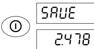
Wenn Sie die Einstellungen abspeichern möchten, drücken Sie die Taste ①. Nach der Speicherung kehrt die Waage automatisch in den Wägemodus zurück.
