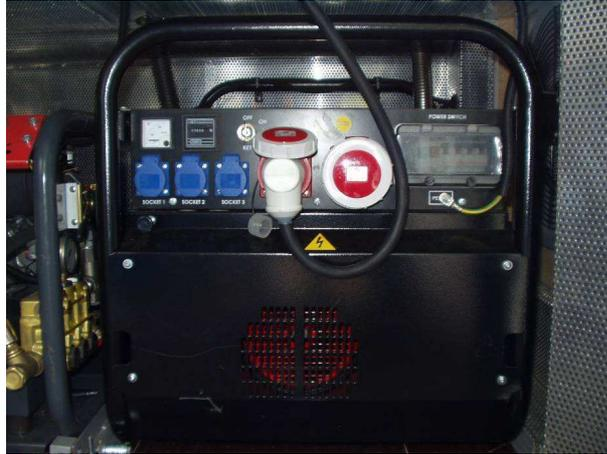
**Nota:** Non attivare troppe macchine contemporaneamente: all'accensione richiederebbero il triplo dell'energia, sovraccaricando l'unità di potenza. Se ciò dovesse accadere spegnere tutte le macchine e riattivare l'unità di potenza.
