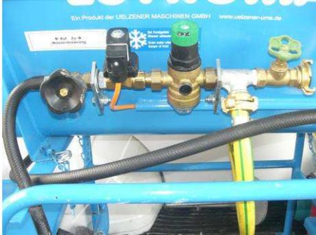
Alimentazione idraulica per miscelatore
