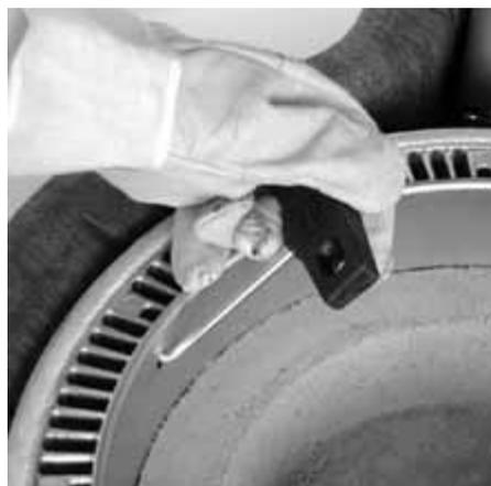
Fig. 5-13 Applicazione della chiave della camera di combustione (nella figura, A1 BO 20i)
