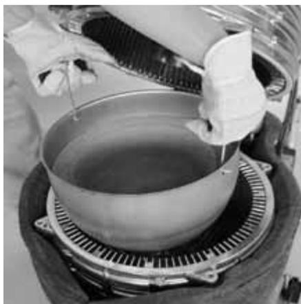
Fig. 5-14 Estrazione dell'elemento refrattario inferiore (nella figura A1 BO 20i)
