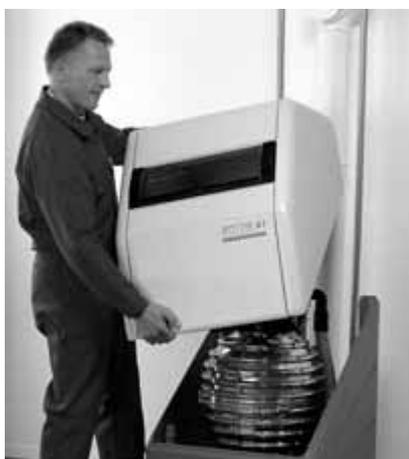
Fig. 5-1 Rimozione della cappa insonorizzante
