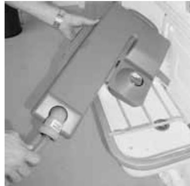
Fig. 5-7 Risciacquo del dispositivo di trattamento della condensa
