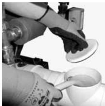
Fig. 5-9 Riempimento del dispositivo di trattamento della condensa attraverso la condotta fumi
