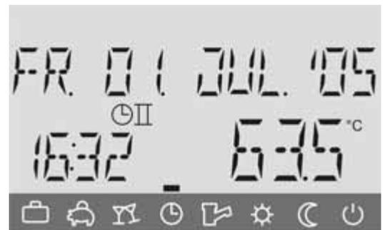
Fig. 4-2 Display indicazione di base THETA 23R
