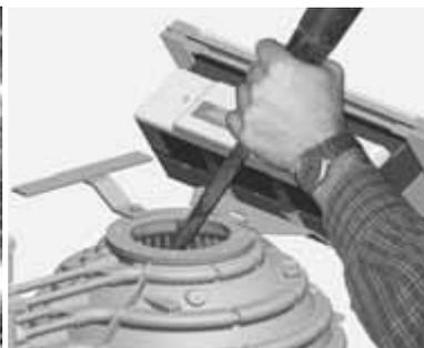
Fig. 5-16 Pulizia della camera di combustione con pulitore ad alta pressione
