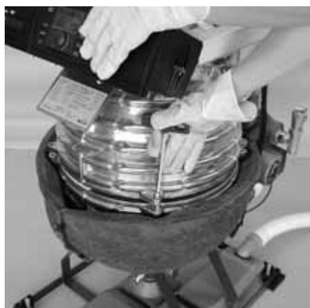
Fig. 5-11 Apertura della camera di combustione
