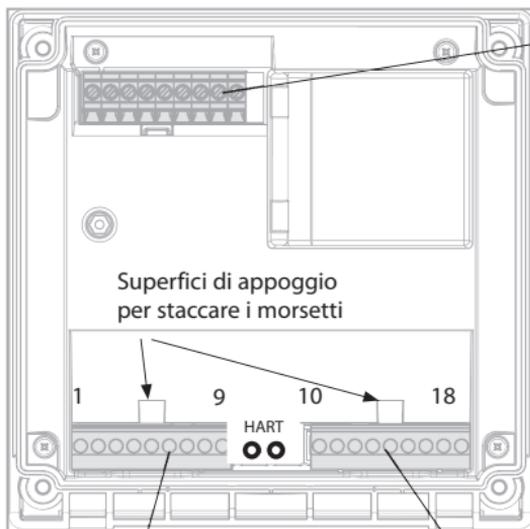
**Collegamento sensore modulo MK-OXY**
