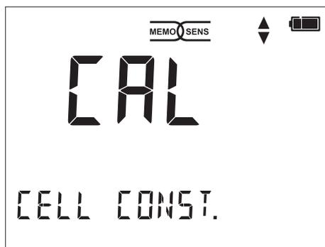
Calibrazione (mediante immissione della costante di cella)
