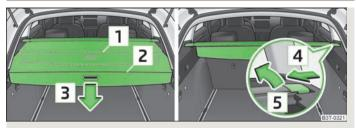
$\mbox{Fig. 70 Bagagliaio: cappelliera avvolgibile {\it I} estrazione della cappelliera avvolgibile } \\ \mbox{ } \mbox{$
