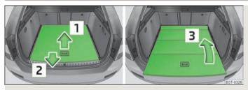
Fig. 75 Bagagliaio: Ripiegamento del piano di carico variabile
