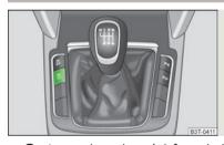
Fia. 172 Tasto per la regolazione del valore di controllo per la pressione dei pneumatici
