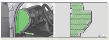
Fig. 186 Copertura della scatola dei fusibili/Rappresentazione schematica della scatola dei fusibili
