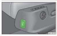
Fig. 58 Interruttore a bilico per ventilazione dei sedili
