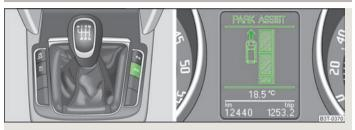
Fig. 121 Attivazione della visualizzazione dell'assistente al parcheggio sul display informativo / display informativo: Ricerca di un parcheggio idoneo
