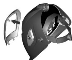
**CA – 20 -huppu voidaan käyttää vain hyväksyttyjen, koon 110 x 110 mm, suodattimien kanssa!** Katso varosa- ja lisävarusteluettelo.
