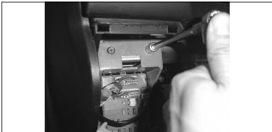
Figure 5: Vissage du boîtier de relais
