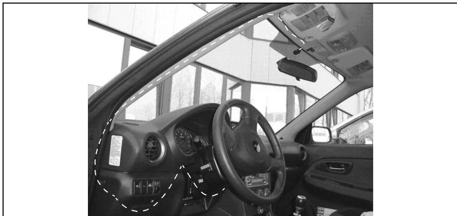
Figure 4: Mise en place du câble de connexion du détecteur
