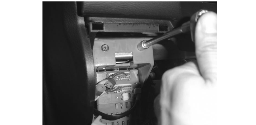
Fig. 5: Fissaggio a vite dello zoccolo della centralina
