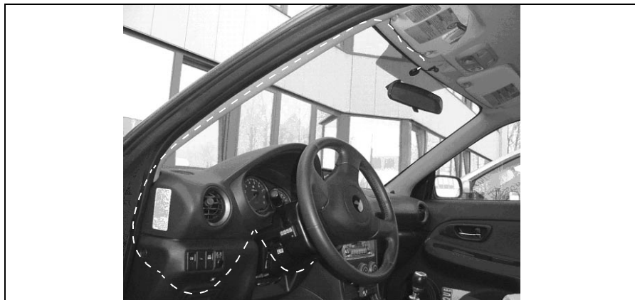
Fig. 4: Installazione del cavo del sensore
