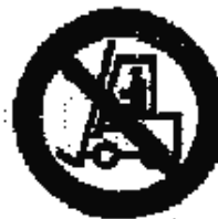
Vietato ai carrelli di movimentazione
