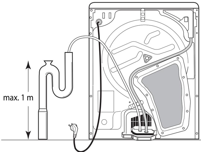
**NOTA:** Per evitare l'effetto sifone, l'estremità del tubo deve essere immersa nell'acqua di scarico. Non torcere e attorcigliare il tubo.
