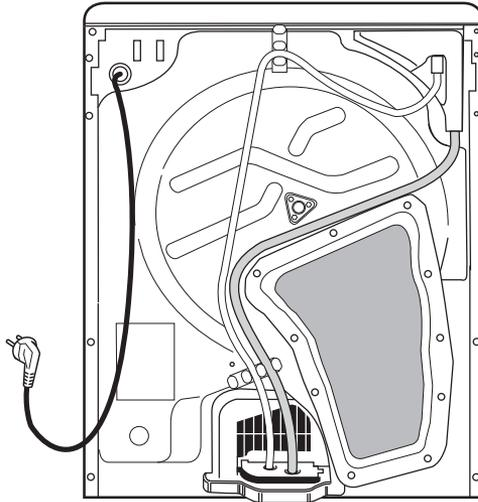
Se possibile, l'acqua può essere scaricata direttamente nell'impianto idraulico domestico. In questo modo si eviterà di dover svuotare la vaschetta di raccolta dell'acqua al termine di ogni ciclo di asciugatura poiché l'acqua di condensa viene scaricata direttamente (vedere il capitolo **SISTEMA DI SCARICO**).
