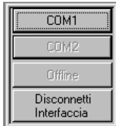
**COM1, COM2** Se una di queste interfacce è disponibile per la comunicazione con un servoamplificatore, quindi non è usata da altri apparecchi o piloti di dispositivi, la scritta corrispondente appare nera e può essere selezionata. Quest'interfaccia va impiegata per l'allacciamento del servoamplificatore.
