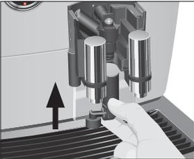
► Applicare la parte inferiore del sistema del latte dal basso sulla parte già inserita.
