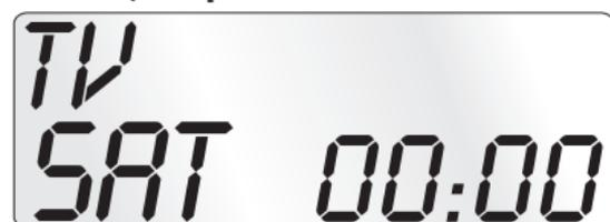
A indicação padrão do visor LCD 1 é composta pelos dados do aparelho actual, p. ex. "TV", pela abreviatura do dia da semana e pela indicação da hora.
