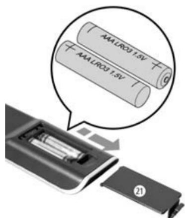
1. Abra la tapa del compartimento de las pilas ② en el sentido de la flecha.
