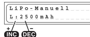
Con questo programma l'accumulatore viene caricato con una corrente di carica relativa alla capacità impostata. Prima di collegare l'accumulatore da caricare, impostate la capacità dell'accumulatore (e quindi la corrente massima) con i tasti INC / DEC (50 ... 7000 mAh). Il caricabatterie calcola automaticamente la corrente di carica 1 C.
