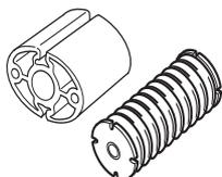
Controllare con regolarità che gli smorzatori non siano deformati o lesi. Controllare che gli elementi ammortizzatori siano integri e ben fissati.
