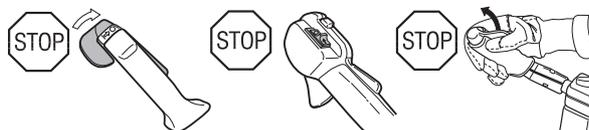
Mettere in moto e controllare che il motore si spenga portando l'interruttore in posizione di arresto.
