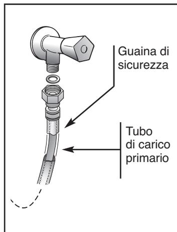
IL tubo di carico dell'acqua primario è inserito in una guaina di contenimento trasparente.
