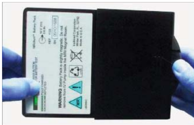
Figura 2-3. Test Pacco Batterie
