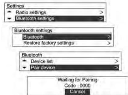
Premere il pulsante **CONFIG** e usare il pulsante **MENU-TUNE** con manopola di regolazione per passare alle impostazioni bluetooth → Bluetooth → Accoppia dispositivo, e poi premere il pulsante **MENU-TUNE**.
