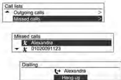
Girare la manopola di regolazione **MENU-TUNE** per controllare la cronologia delle chiamate ed effettuare una chiamata.
