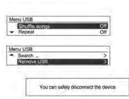
Premere il pulsante **MENU-TUNE** dalla modalità di riproduzione per visualizzare il menu USB. Girare la manopola di regolazione **MENU-TUNE** per passare a Rimuovi USB e quindi premere il pulsante **MENU-TUNE** per visualizzare il messaggio di conferma che è sicuro rimuovere il dispositivo USB. Scollegare il dispositivo USB dal terminale di collegamento USB.
