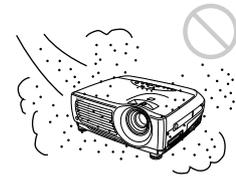
Non installare l'apparecchio in un luogo eccessivamente polveroso, altrimenti il filtro dell'aria potrebbe intasarsi. In questo caso potrebbe verificarsi un aumento della temperatura interna del proiettore. Pulire il filtro periodicamente.
