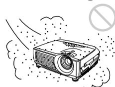
Stellen Sie das Gerät nicht an einem Ort auf, an dem es übermäßig viel Staub ausgesetzt ist. Andernfalls wird der Luftfilter blockiert. Wenn die Luft im Filter nicht mehr richtig zirkulieren kann, kann es im Projektor zu einem Temperaturanstieg kommen. Reinigen Sie den Filter regelmäßig.
