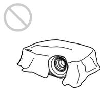
Evitare di coprire le prese di ventilazione (aspirazione/scarico) onde evitare il surriscaldamento interno.
