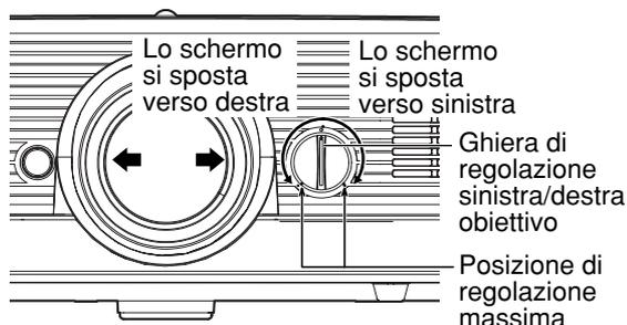
**Attenzione** • Per regolare, spostare la ghiera di regolazione sinistra/destra obiettivo su qualsiasi posizione fino alla posizione di regolazione massima. Se si gira la ghiera usando forza, si potrebbe causare un malfunzionamento.
