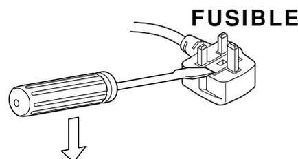
Come sostituire il fusibile. Con un cacciavite aprire il comparto del fusibile e sostituire il fusibile.
