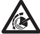
Una volta arrestato il motore fermare la rotazione del coltello portando il coltello sul terreno. La freccia indica la direzione di rotazione.
