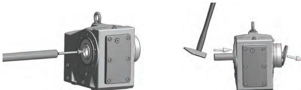
Fig. 3-6: smontaggio del coperchio a vite montato di fabbrica
