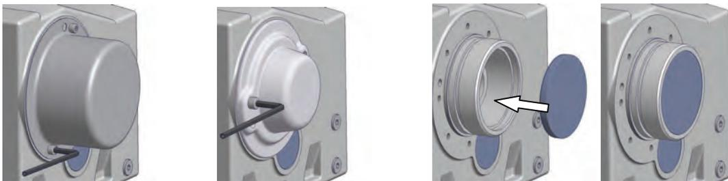
Figura 3-13: montaggio del coperchio di protezione opzione SH, opzione H e opzione H66
