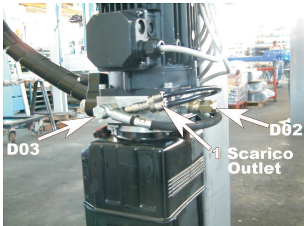
Fig.48 Allacciamento impianto idraulico Fig.48 Raccordement hydraulique
