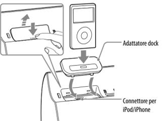
Quando non si utilizza un iPod/iPhone, tenere il pannello chiuso. Per rimuovere l'adattatore dock, tirarlo verso l'alto con un'unghia o un oggetto piatto utilizzando la fessura all'interno dell'adattatore.
