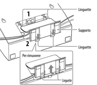
1 Inserire le linguette del supporto nella sezione con le scanalature dell'unità.
