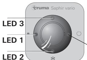
Als het apparaat via deze toetschakelaar wordt aangezet, dan wordt automatisch teruggekeerd naar de fabrieksinstellingen (COOL, FAN HIGH, TEMP. 21 °C).
