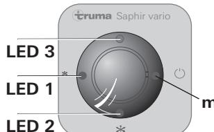
Hvis anlægget kobles til vha. denne afbryder, stilles der automatisk tilbage til fabriksindstillingerne (COOL, FAN HIGH, TEMP. 21 °C).
