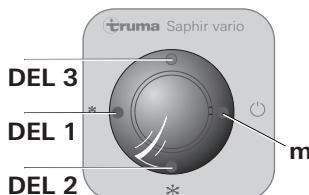
En cas de mise en marche via cet interrupteur à touche, l'appareil est automatiquement réinitialisé sur les réglages d'usine (COOL, FAN HIGH, TEMP. 21 °C).
