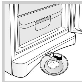
5. Anumite modele sunt dotate cu un sistem numit SISTEMA DRAIN care dirijează apa spre exterior (vezi figura).
