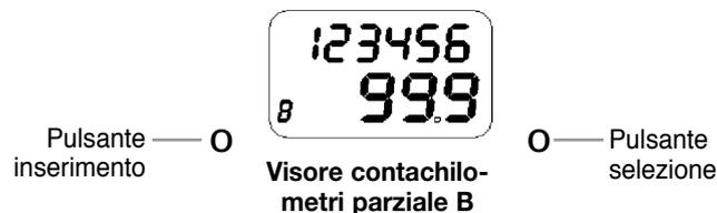
il contachilometri totalizzatore, mentre la seconda mostra in sequenza il contachilometri parziale A, B ed il livello intensità illuminazione del quadro strumenti.
