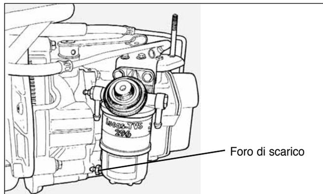
**Sostituzione filtro carburante (motori a benzina)**
