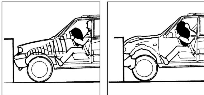
co in collisioni frontali e angolari di media e forte intensità. Il sistema Air Bag non è visibile finché non è attivato. Siccome il sistema rileva la severità dell'incidente, alcune collisioni frontali non causano la fuoriuscita degli Air Bag. Gli Air Bag sono infatti progettati per non scoppiare nei capottamenti, tamponamenti o incidenti a bassa velocità frontali o laterali, in quanto la necessaria protezione è fornita dalle cinture di sicurezza.
