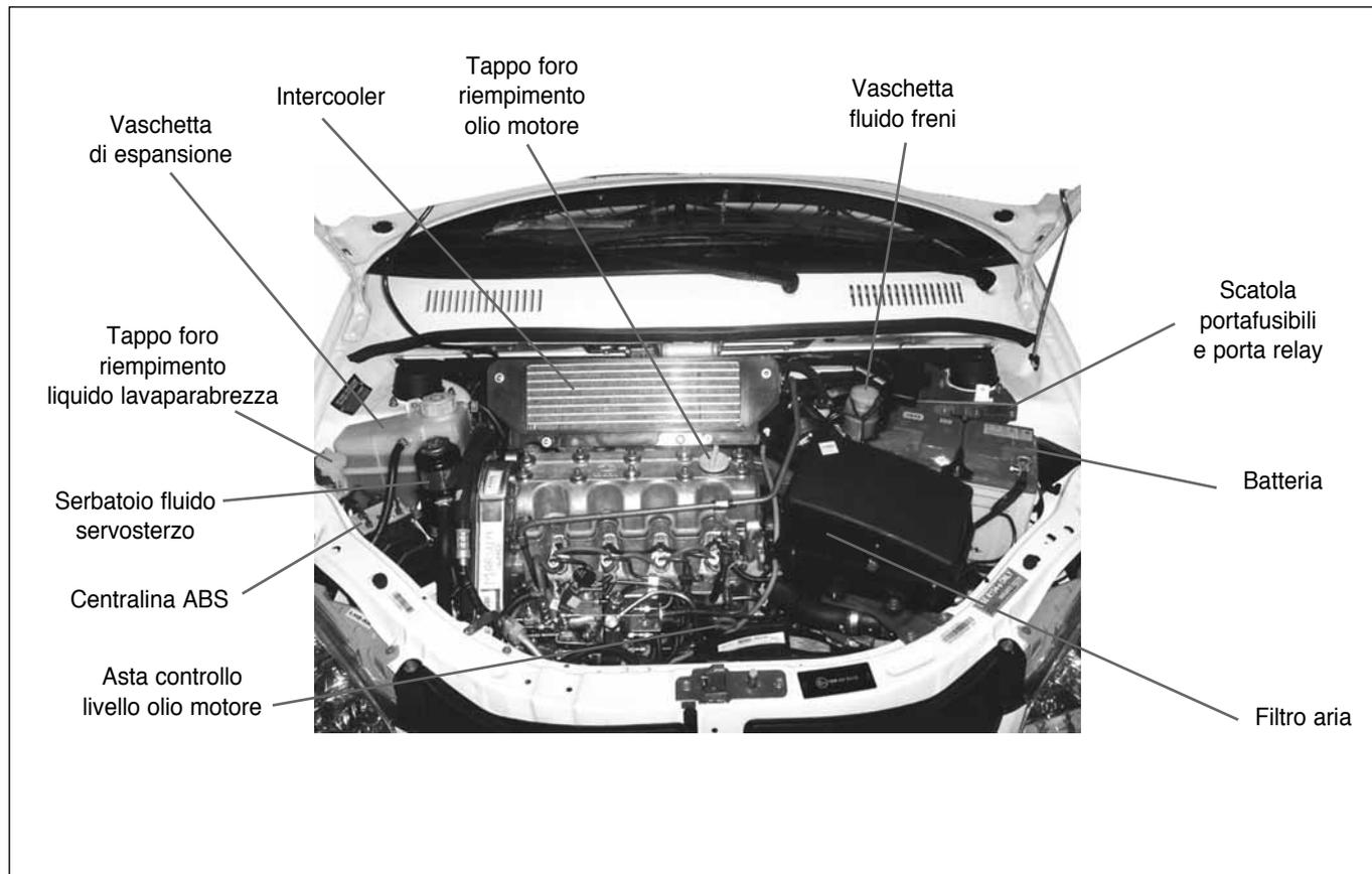
Interventi di manutenzione nel vano motore (versione benzina)
