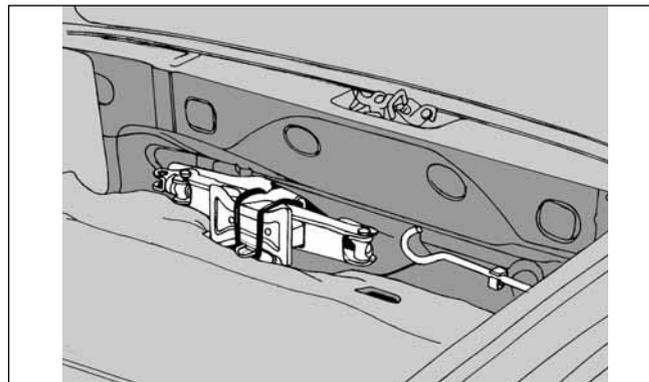
ria dietro alla ruota anteriore per sostituire una ruota anteriore e prima della ruota posteriore, nel passo, se è necessario sostituire una ruota posteriore. Fare riferimento al disegno accanto ed alla targhetta adesiva incollata sul martinetto stesso.
