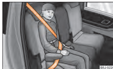
Fig. 110 Seggiolino per bambini del gruppo 3 montato nel senso di marcia sul sedile posteriore
