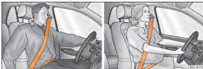
Fig. 94 Posizione del nastro diagonale e del nastro addominale della cintura / posizione del nastro della cintura per le donne incinte
