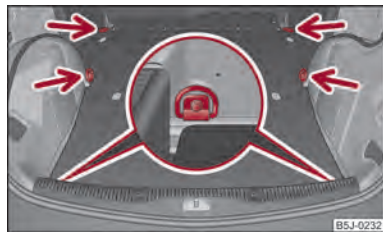
Fig. 162 Vano di carico: Occhielli di ancoraggio
