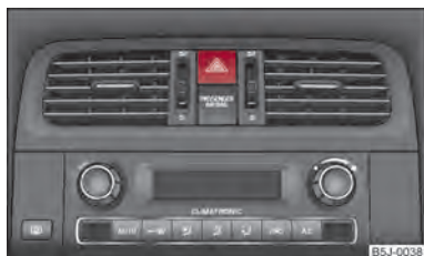
Fig. 24 Plancia: interruttore lampeggiatori d'emergenza
