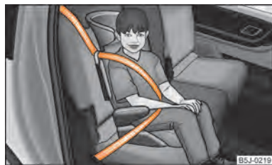
Fig. 109 Seggiolino per bambini del gruppo 2 montato nel senso di marcia sul sedile posteriore
