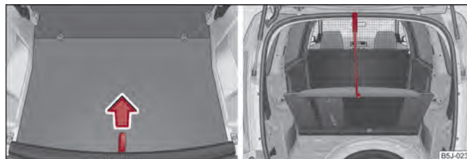
Fig. 164 Coppio per il sollevamento del piano di carico / fissaggio del piano di carico con un gancio di plastica
