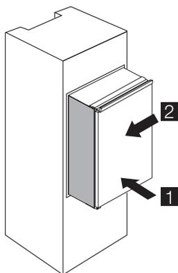
3. Regolare l'apparecchio nella nicchia. Accertarsi che la distanza fra l'apparecchio e il bordo anteriore del mobile sia di 44 mm. Il copricerniera inferiore (nel sacchetto degli accessori) permette di controllare che la distanza fra l'apparecchio e il mobile della cucina sia corretta. Accertarsi che lo spazio fra l'apparecchio e il mobile sia di 4 mm.
