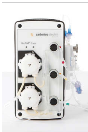
Figura 18: Vista del pannello frontale con tutti i tubi installati per il modo operativo Filtrazione
