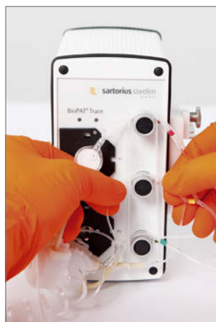
Figura 20: Posizionamento dei tubi delle valvole sull'apparecchio
