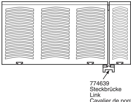
Fig. 2: Basisgerät und Erweiterungsmodul verbinden
