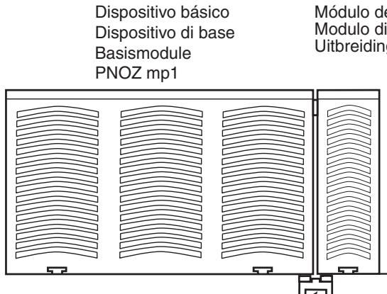
Fig. 2: Conectar el dispositivo básico y los módulos de ampliación
