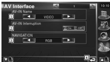
1 Imposta un messaggio da visualizzare quando si seleziona un sistema collegato tramite la porta di ingresso AV. (☑ VIDEO)
