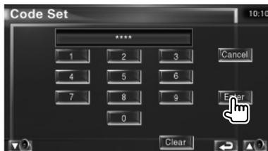
Ora, il codice di sicurezza è stato registrato. Se si preme il tasto di ripristino o si scollega il ricevitore dalla batteria dopo la registrazione del codice, sarà necessario reimmettere il codice di sicurezza registrato.
