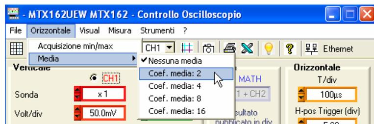
Quando un calcolo di valore medio (media) viene attivato, il suo coefficiente è visualizzato nella finestra « Traccia Oscilloscopio »:
