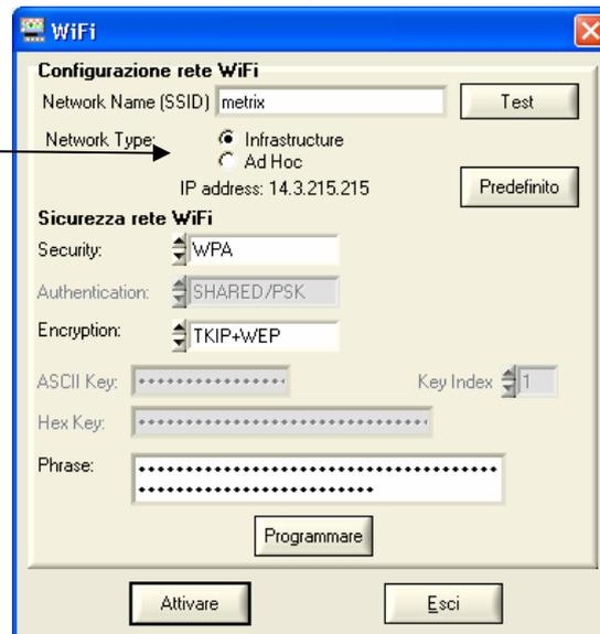
Per la programmazione dei parametri WiFi, riferitevi alla documentazione del vostro punto d'accesso senza filo e riproducete la sua programmazione in modo identico sull'MTX 162UEW.
