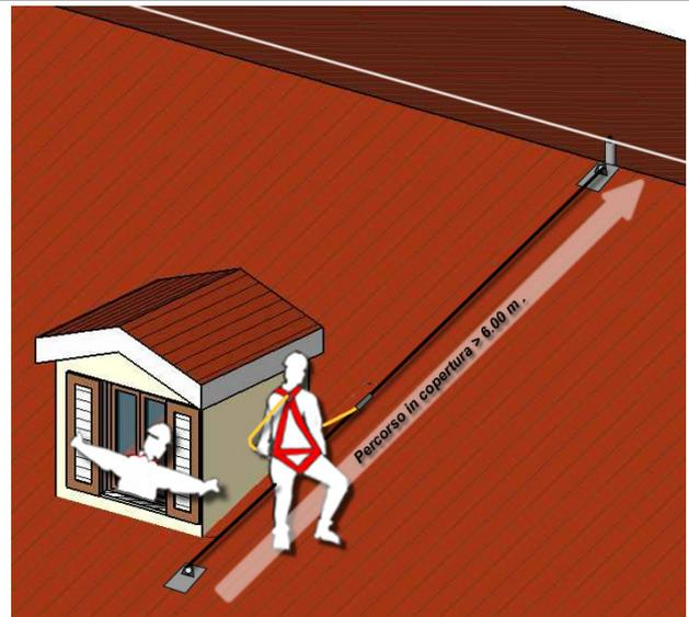
La distanza tra un punto di ancoraggio e quello successivo per consentire all'operatore un facile spostamento non dovrebbe superare 1.50 m, anche se è tollerabile ergonomicamente una distanza di 2.m che però rende assai difficoltosa la capacità di spostamento dell'operatore. Distanze superiori ai 2. m. sono assolutamente insuperabile da un doppio cordino di 2 m. in quanto l'operatore sarebbe costretto a sganciarsi per poter raggiungere quello successivo.
