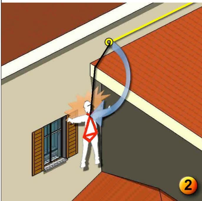
Nel caso di particolare disallineamento laterale tra l'ancoraggio ed il punto di potenziale caduta deve essere posta particolare attenzione alla posizione degli ancoraggi o delle linee di ancoraggio orizzontali in modo da eliminare o ridurre le conseguenze affinché l'utilizzatore non colpisca ostacoli durante la caduta
