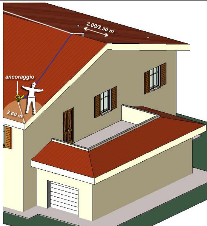
Disporre un ancoraggio supplementare a 2,60 m lungo la bisettrice dell'angolo della copertura a cui fissare il cordino di 2 metri che è servito per accedere alla copertura come integrativo al sistema di trattenuta principale consente di evitare la caduta dell'operatore oltre il piano della falda.
