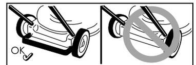
Pericolo di ferite – lavorare solo con la staffa posteriore di sicurezza montata.
