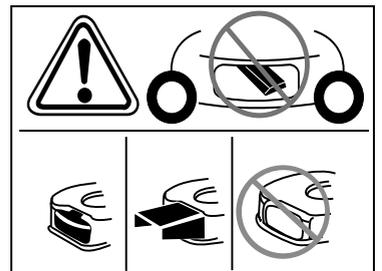
Pericolo di ferite – lavorare solo con l'espulsore montato.
