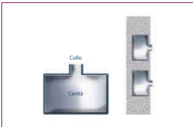
Figura 3.8 I “risonatori” acustici sono volumi aperti contenenti aria. Posti generalmente negli spessori dei muri, servono ad attenuare il suono a determinate frequenze.
