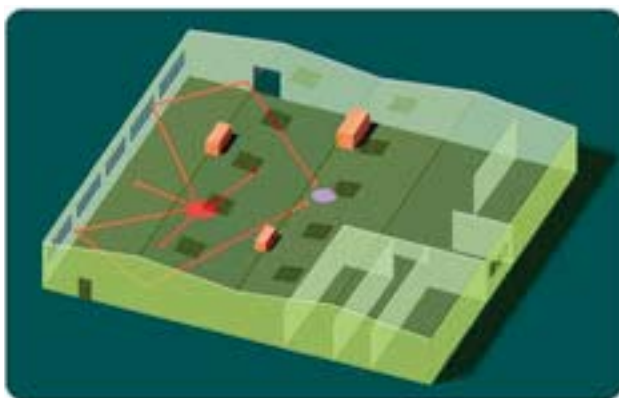
Figura 3.10 L'uso di modelli consente di simulare i diversi cambiamenti di assetto del luogo di lavoro e di valutare i relativi benefici (RayPlus® © software e gentile concessione di INRS - Francia)
