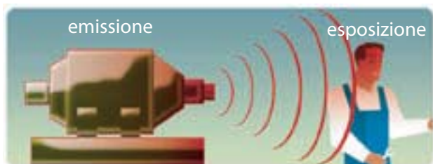
Figura 6.1 Riducendo le emissioni di rumore dei macchinari si riduce l'esposizione dei lavoratori.
