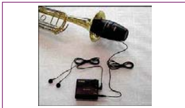
Figura 8.4 Sistema dell'ottone silenzioso Foto © & gentile concessione di Yamaha Music
