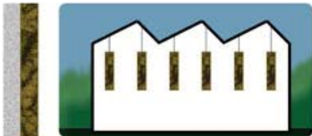
Figura 3.6 Si possono installare materiali porosi sulle pareti delle officine, oppure appenderli ai soffitti in qualità di deflettori per attenuare i suoni ad alta frequenza.
