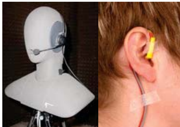
Figura 2.13 Misurazioni del rumore vicino all'orecchio secondo i metodi HATS e MIRE © e gentile concessione dell'Health and Safety Executive – Gran Bretagna Sinistra: Simulatore di testa e torso (fonte HEAD Acoustics GmbH, Germania) Destra: MIRE
