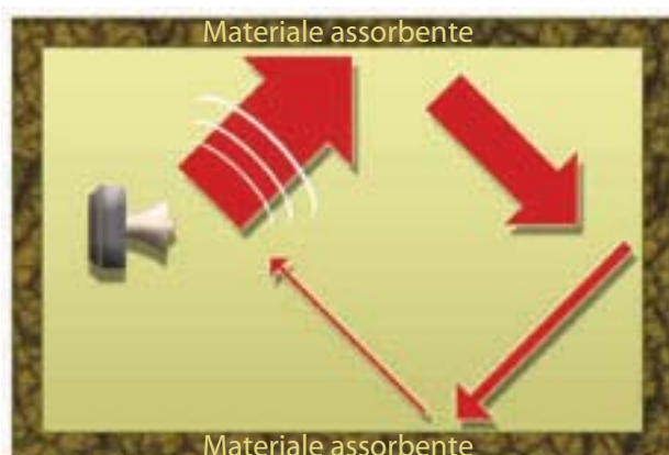
Figura 3.2: I materiali e i dispositivi assorbenti riducono il suono riflesso, consentendo di ridurre l'effetto dell'ambiente.
