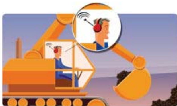
Figura 5.11 In una postazione di lavoro in cui occorre poter comunicare, il lavoratore utilizza cuffie dotate di un sistema elettronico di comunicazione.
