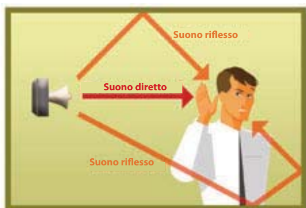
Figura 3.1: Il suono emesso da una fonte sonora si riflette sulle pareti del luogo di lavoro. L'esposizione del lavoratore combina il suono riflesso e quello diretto.
