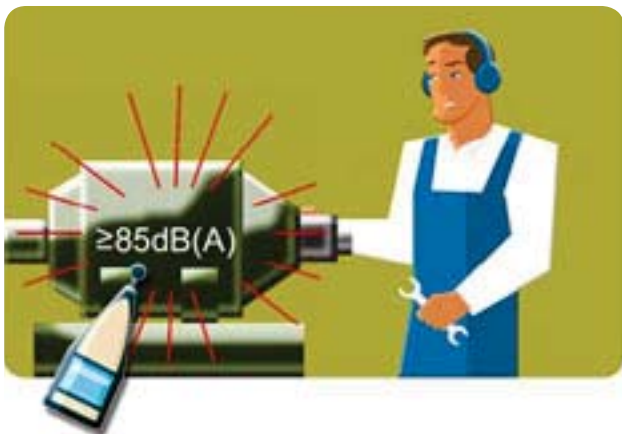
Figura 5.2 L'esposizione al rumore raggiunge od oltrepassa i valori superiori di esposizione che fanno scattare l'azione; i lavoratori devono utilizzare i dispositivi di protezione dell'udito.
