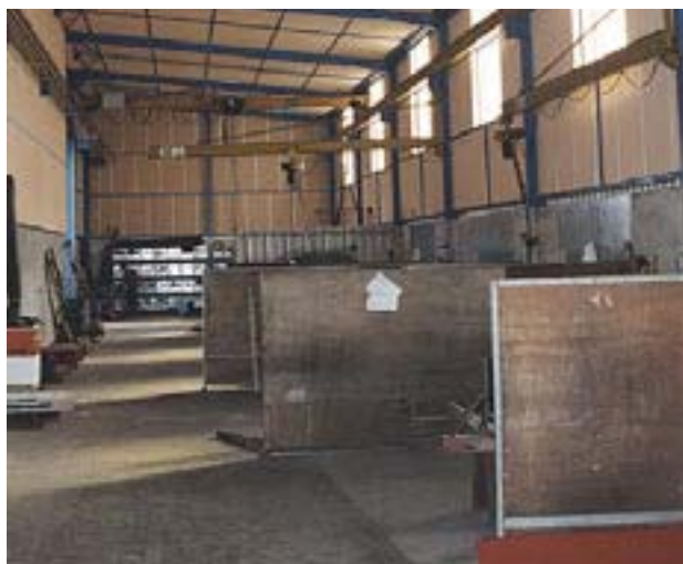
Figura 4.18 Metallurgia – Schermo © Yves Cousson – Gentile concessione di INRS - Francia
