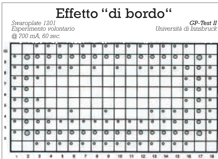
Fig. 7: Termogramma di un elettrodo neutro, misurato attraverso il test GP. I valori di temperatura più elevati registrati in corrispondenza dei bordi sono sintomatici di una più elevata densità di corrente.
