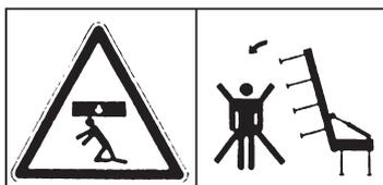
Possibile apertura degli elementi laterali della macchina: tenersi a distanza di sicurezza. Non avvicinarsi/ sostare nell'area di apertura di questi elementi. Quando si aprono gli elementi laterali, verificare sempre che sia presente spazio a sufficienza.
