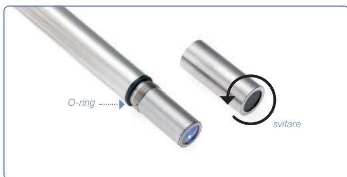
Figura 13: Sostituzione del tappo ODO
