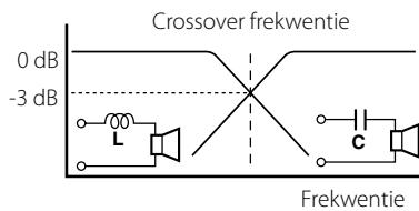
**Spoel (L):** Stuurt lage frekwenties door en blokkeert de hoge frekwenties. (Laag-door)
