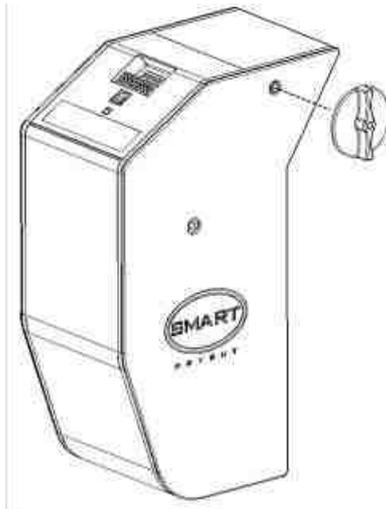
Ruotarla in senso antiorario, finché non arriva completamente a fine corsa, come mostrato nella Figura sottostante.
