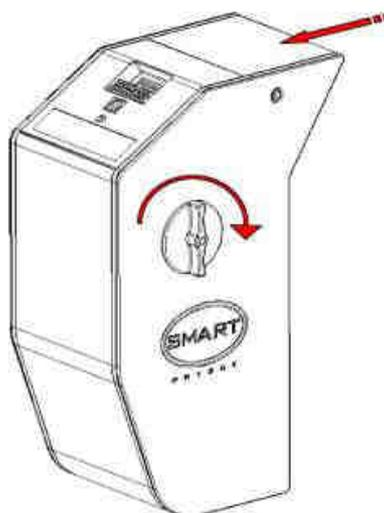
Quando la banconota è stata trasferita nel meccanismo di transazione, riportare i rulli nella loro posizione, ruotando la vite in senso orario, come mostrato nella Figura sottostante.
