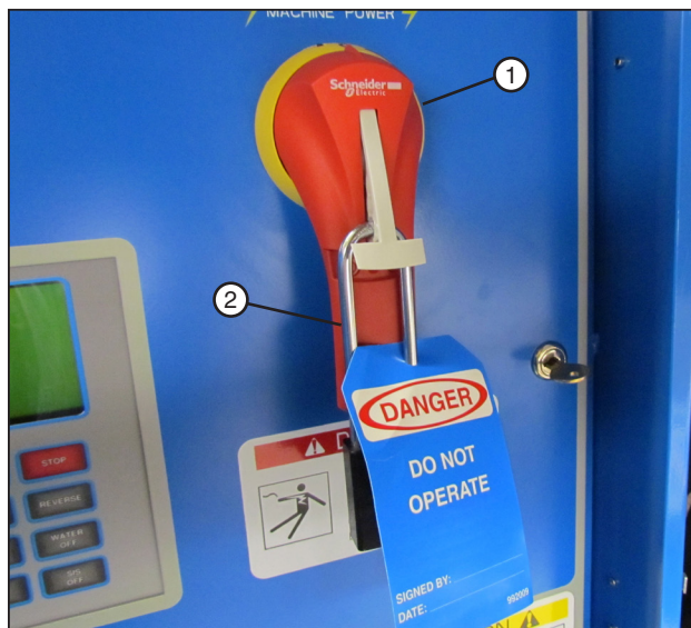
Figura 13-1 1. Sezionatore principale 2. Lucchetto
