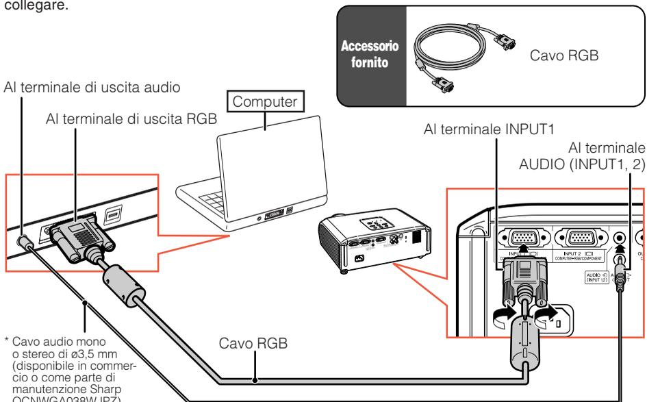
\* Quando si usa il cavo audio mono da  $\varnothing 3,5$  mm, il livello del volume sarà la metà del livello prodotto quando si utilizza il cavo audio stereo da  $\varnothing 3,5$  mm.
